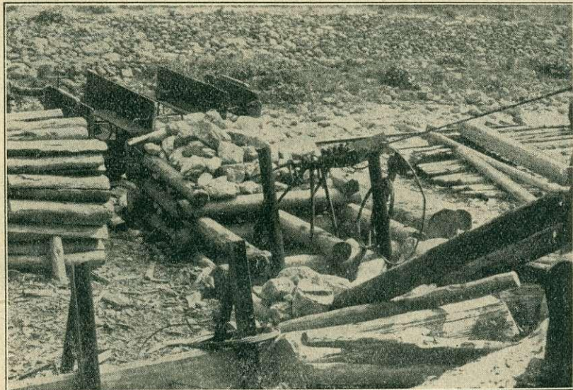
A Steinberg-kötéleregető alsó állomása a kötélfeszítőszerkezettel. Háttérben az erdei vasút látszik.
