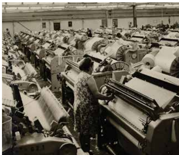
A Lakástextil Vállalat szövőcsarnoka 1975-ben, új P–105-ös cseh szövőgépekkel | Weaving workshop of the Home Textiles Company in 1975 with new Czech P 105 machines Archív fotó: Jákfalvi Elemér. Forrás: Berzsényi Dániel Könyvtár helyismereti gyűjteménye
