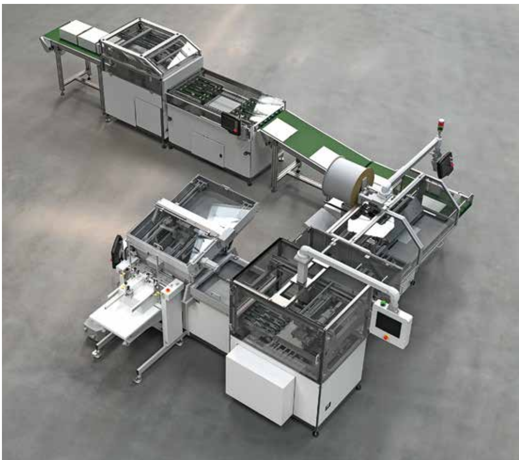
Automatizált Renz Inline 500 Compact – digitális naptárgyártás okosan integrálva egy komplett folyamatba
