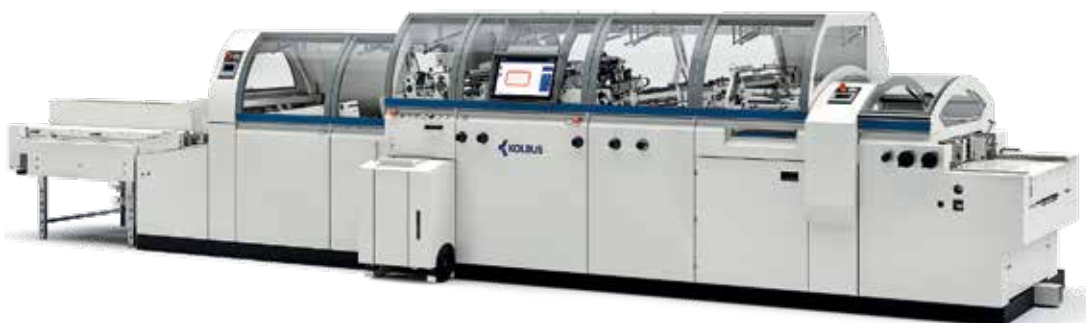
KOLBUS DA 370 táblakészítő gép – Smart flow & Digital ready – 65 ütem/perc teljesítmény
