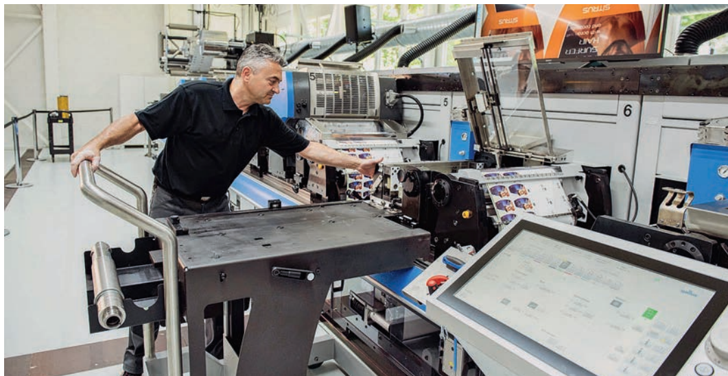
Néhány percen belül elvégezhető a nyomóegységek cseréje. (Forrás: Gallus Ferd. Rüesch AG)
