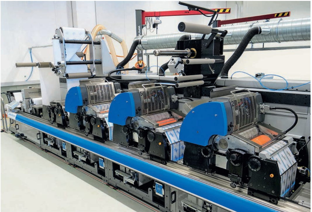
Keskenypályás tekercsnyomógép, UV-ofszet nyomtatóegységekkel felszerelve. Igény szerint további nyomó- és befejező egységekkel konfigurálható. (Forrás: Gallus Ferd. Ruesch AG)
