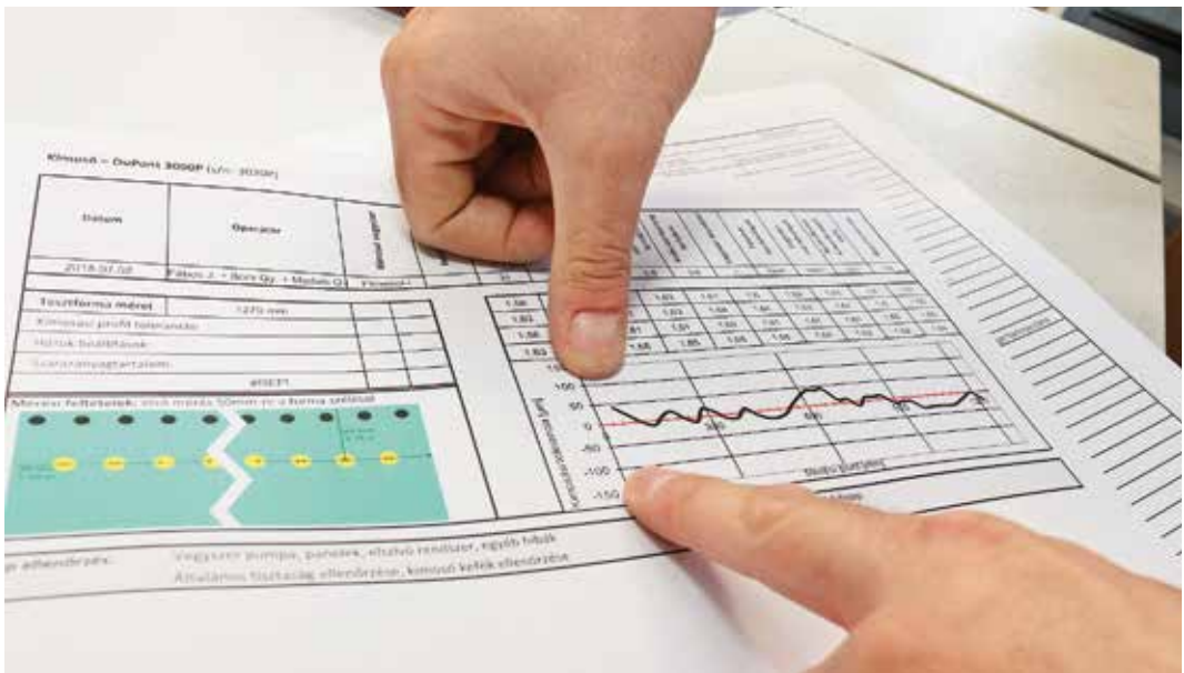
Megnyugtató, amikor a gyártási paraméterek nagy biztonsággal a FlexoExpert szigorú toleranciasávjain belül mozognak
