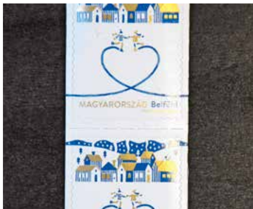
Kisív nagyított bélyegképe – riccelés, biztonsági riccelés és vonalperforálás
