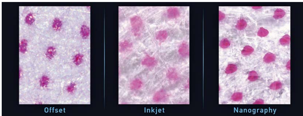
Ofszet, inkjet és nanográfias nyomtatású rácspontok ránézeti felvétele
