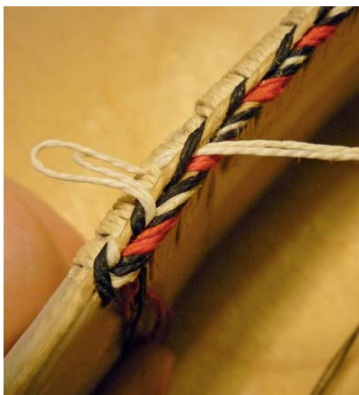
7. fénykép. A második díszítő öltéssor készítése a B jelű (második) másodlagos oromszegő alapon
