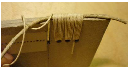
1. fénykép. Az elsődleges oromszegő alap elkészítése
