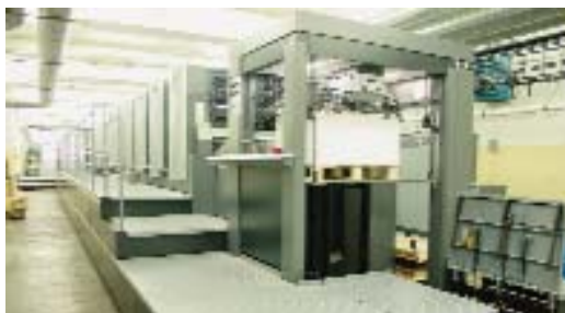
Heidelberg CX-102-6LYYL nyomógép
