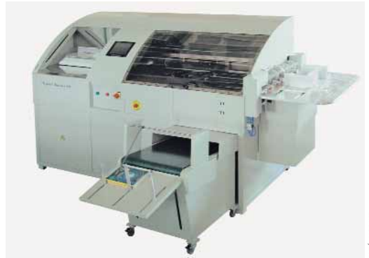
Perfect Binder 420 zárt PUR technológiával
