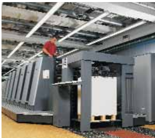
9. ábra. Nyomatás és felületnemesítés egy menetbe – Heidelberg CD74UV nyomógép
