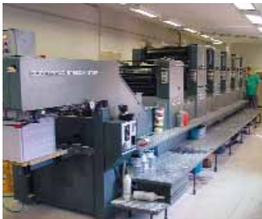
8. ábra. Öt nyomóműves íves ofszet nyomógép
