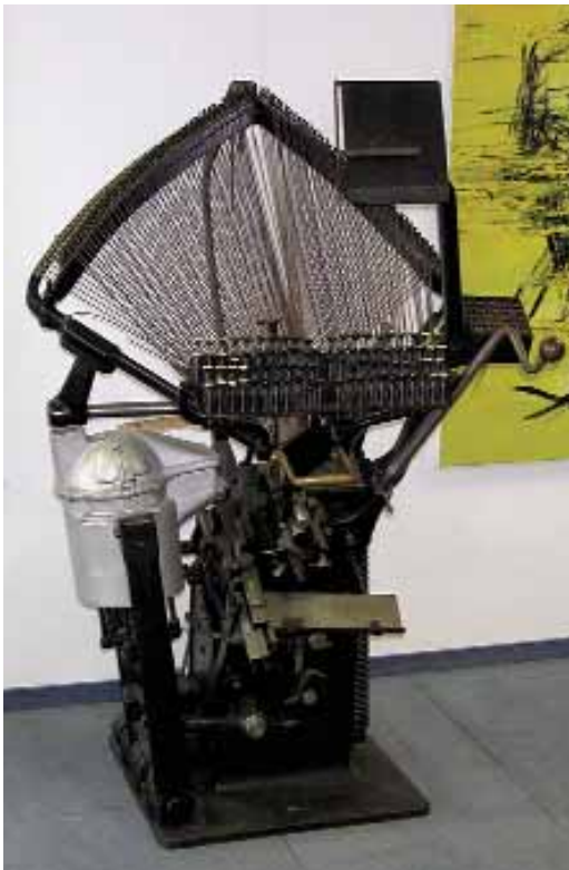
2. ábra. Muzeális értékű Linotype szedő- és öntőgép
