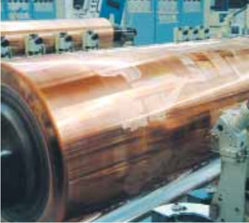
10. ábra. A nyomóelemeket hordozó Ballard vörösrézréteggel bevont mélynyomóforma henger
