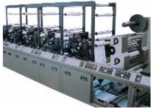
6. ábra. Flexó- és szárázofszet rendszerű, ún. hibrid nyomógép
