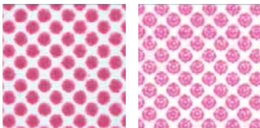
Színtelítettség a formán – 175 lpi hagyományos- és Concentric pontok
