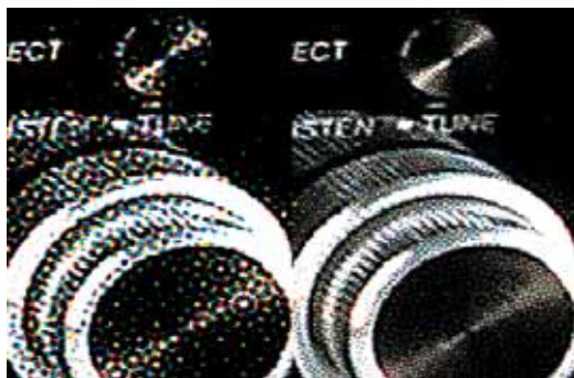
175 lpi hagyományos- és 310 lpi Concentric raszerpontok a nyomaton
