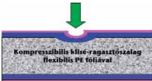
1. ábra. Klisé-ragasztószalag szerkezete
