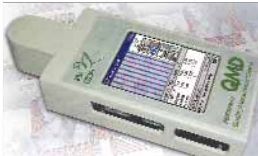
3. ábra. QMD típusú digitális mikroszkóp kiemelt kategóriájú biztonsági nyomatok ellenőrzésére
