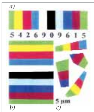
6. ábra. Mikroszínkód (Micro Color Code) a gyakorlatban: a) A termék felületre nyomtatva; b) Többretegű nyomathordozó, mikroszínkód-tartalmú rétegei; c) Termékben diszpergált mikroszínkód-részecskék mikroszkópi képe. A színkód jelentéstartalma: fekete = 0; barna = 1; vörös = 2; narancs = 3; sárga = 4; zöld = 5; kék = 6; lila = 7; szürke/ezüst = 8; fehér = 9, de akadnak olyan titkos színkódok is, mint például a Secutag rendszeré
