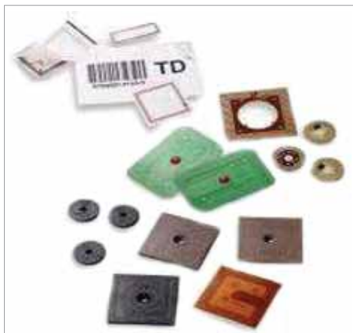
1/a és 1/b. ábra. Rádiófrekvenciás azonosító (RFID) címkék. Az aktív típus saját feszültségforrással rendelkezik, a passzív az antennája segítségével a környezet rádióhullámainak átalakításával hozza létre a mikroáramköröi működtetéséhez szükséges villamos energiát
