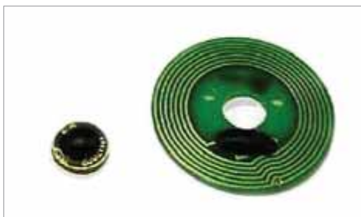
1/a és 1/b. ábra. Rádiófrekvenciás azonosító (RFID) címkék. Az aktív típus saját feszültségforrással rendelkezik, a passzív az antennája segítségével a környezet rádióhullámainak átalakításával hozza létre a mikroáramköröi működtetéséhez szükséges villamos energiát
