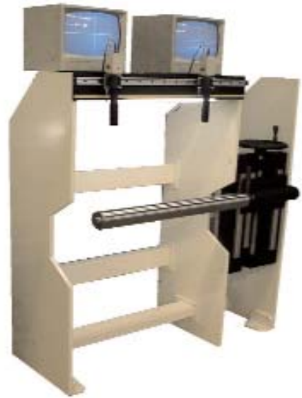
14/c ábra. Varga-gyártmányú kliséragasztó pad. Motoros megfigyelõkamerái és digitális kijelzõjének segítségével kifogástalan ragasztást végez
