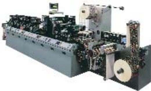
11/a ábra. Euroflex 400M, változtatható nyomat-szélességű, stancoló, max. tizenkétszines, flexó- és szitanyomó, stancoló gép
