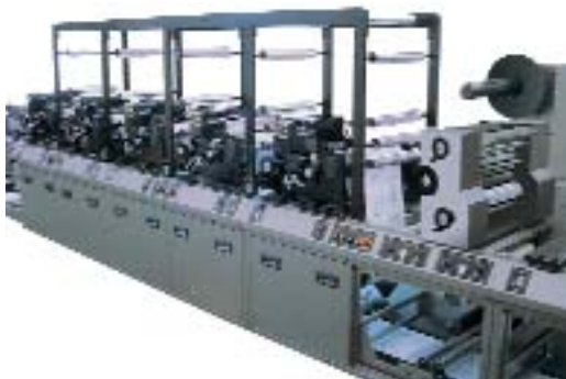
11/b ábra. Euroflex Modular Press. Flexó- és szárazofszetrendszerű nyomógép
