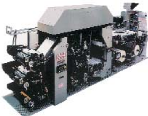
11/c ábra. Euroflex CID 400. Több tekerccszélességgel gyártott nyomógép film-, címke-, kartonnyomtatás és rotációs stanolás céljára. Vízalapú és UV-flexó festékkel egyaránt üzemeltethető
