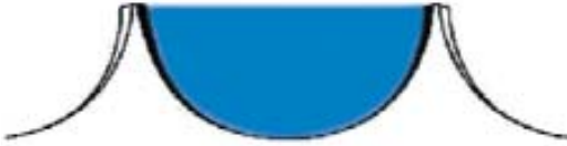
5. ábra. A csészenyílás és a stég arányát korábban a 8:1 aránytól akár a 14:1 arányig is növelték, ez vékony, éles csészefalakat eredményezett, ezért a klisé könnyen sérült
