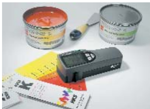
9/b ábra. Techkon gyártmányú SpektroDens típusú denzitométer/spektrofotométer, színvizsgálati célokra
