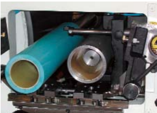
14/b ábra. Varga-megoldású, fokozatmentes formahengerhajtás, oldalcsereológó rendszerrel
