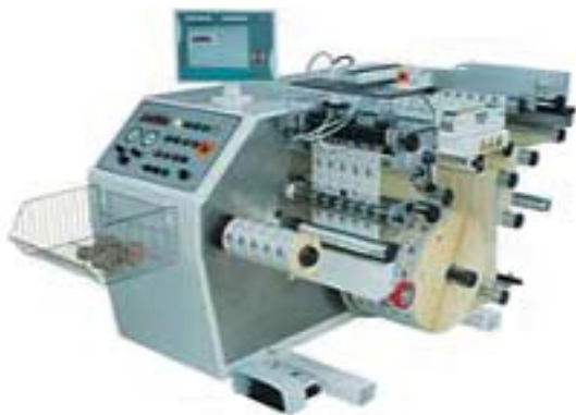
9/a ábra. LeoMat márkájú címkenyomtató, alapfelszerelésben vágó-, kiserelő- és hibaellenőrző funkciókkal
