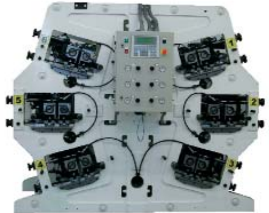
14/a ábra. Varga-gyártmányú, központi ellennyomó-hengeres flexó nyomógép
