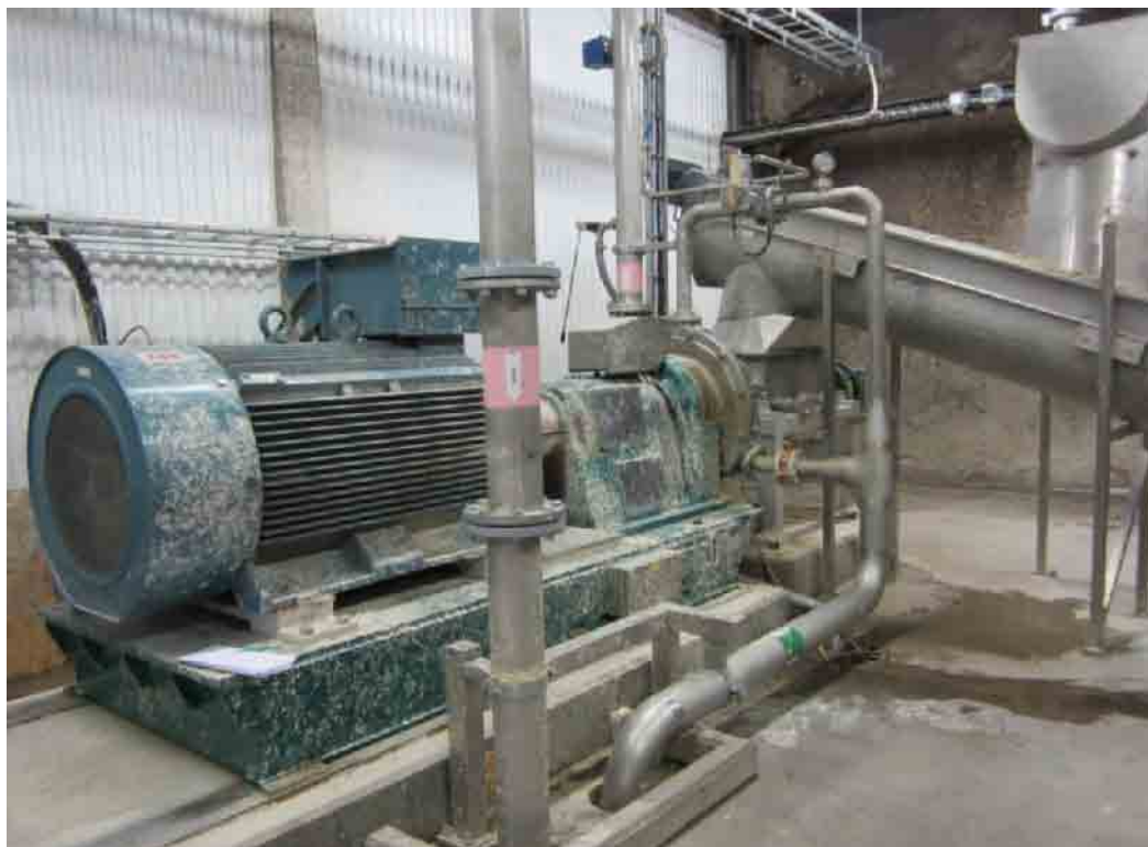
The new Krima disperser is used for treatment of wet-strength broke and storage pulp Az új Krima diszpergálógép a nedvesszilárdságú papírgyári selejt és a tárolt papír megfelelő kezelésére egyaránt használható
