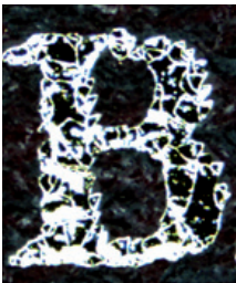
11. a ábra BAIER aranyozó 150 °C-on készült nyomtatás 3D-s mikroszkóppal készített felvétele
