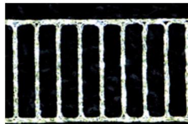
10. b. ábra BAIER aranyozó 150 °C-on készült nyomtat 3D-s mikroszkóppal készített felvétele
