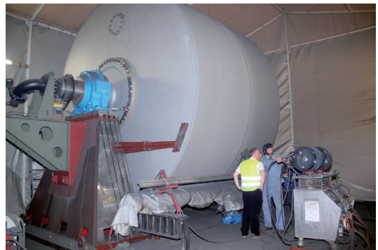
A világ egyik legnagyobb acél Yankee hengere, gyártás közben
