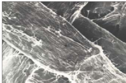
1. ábra: Papíripari cellulózrost felületének elektronmikroszkópos képe
