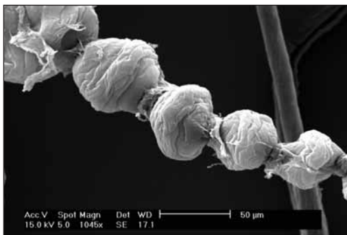
2. ábra. Lucfenyőrost gömbduzzadása foszforsavkezelés után
