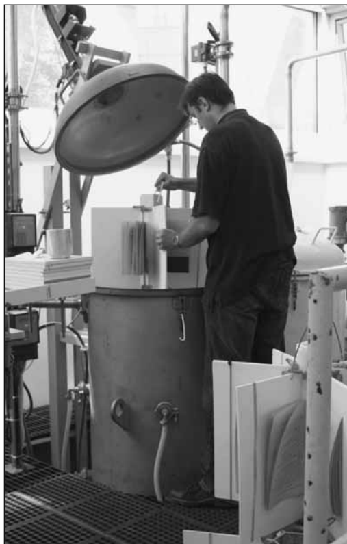
3. kép. Kötetek savtalanítása (Bookkeeper módszer)
