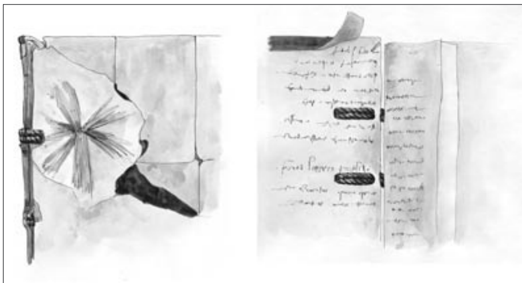
1. kép. A bordák rögzítése a fatábla külső és belső oldalán
