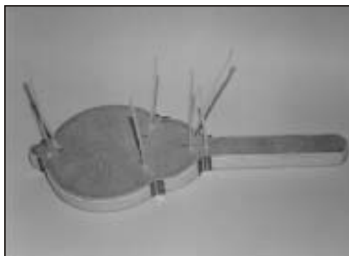
2. kép. A famagon száradó papírváz a negatív sarokban szorító bilincsekkel
