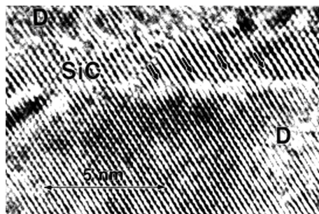
4. ábra • Szilíciumionok implantálásával gyémántban létrehozott kristályos, rendezett szilíciumkarbid szemcse (Pécz B. és Forschungszentrum, Rossendorf)
