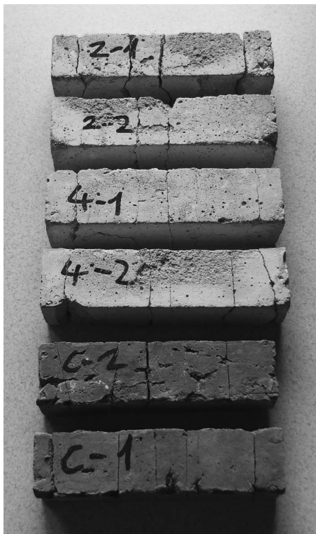
6. ábra • A habarcschasabok törésük után (a két alsó kiégetetlen márgából készült)
