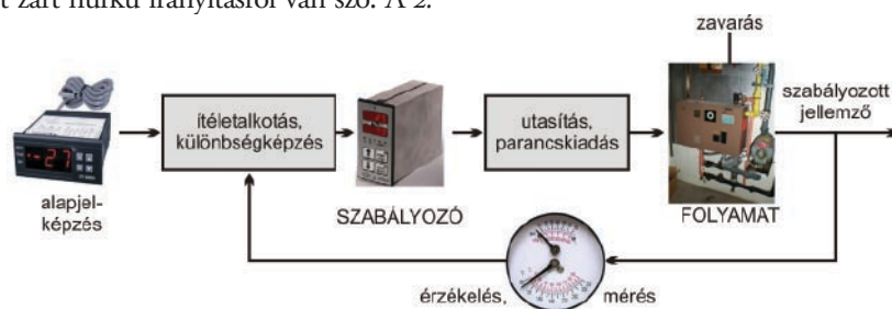
2. ábra • A szabályozás működési vázlata
