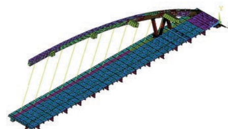
10. ábra • A mederhíd háromdimenziós végeselemes számítási modelljének részlete
