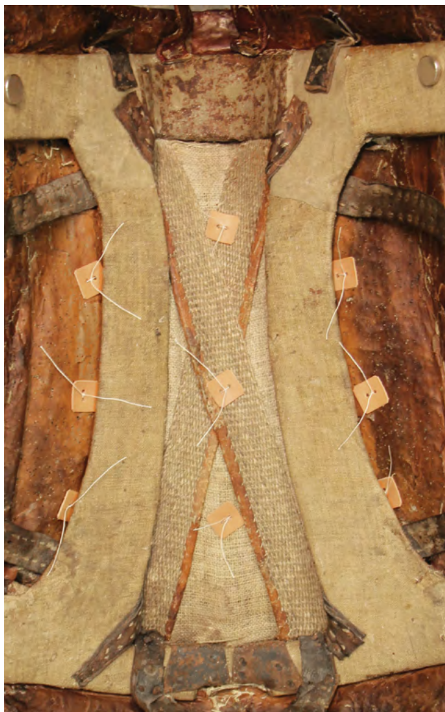
46. kép. Az ülés-kárpit behúzóinak lekötözése
