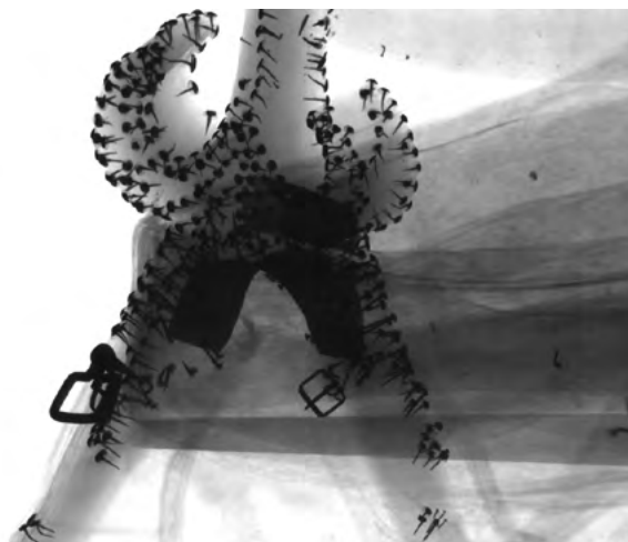
12. kép. Az első villa megerősítése röntgenfelvételen
