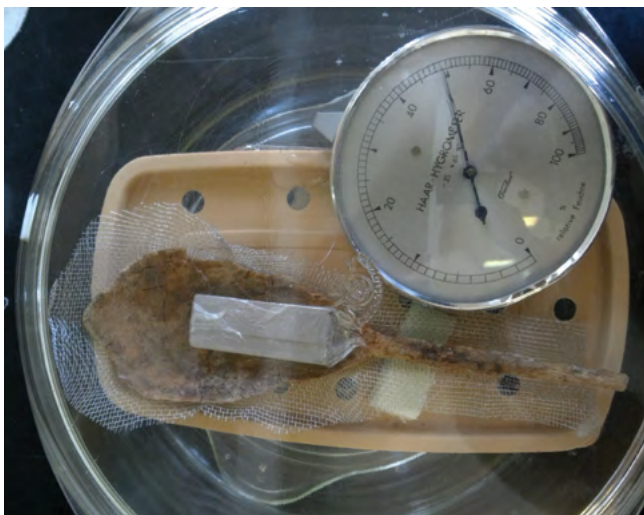
16. kép. A zárt edényben magnézium-nitrát só telített oldata felett elhelyezett kanál
