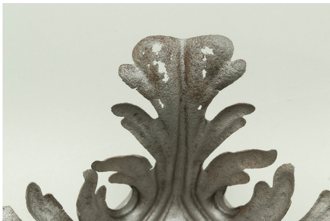
14. kép. Az előrehaladott korrózió a lemezdiszen, tisztítás után.
