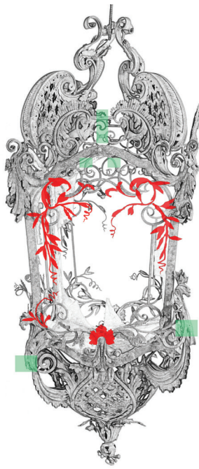
3. ábra. A lámpa C. oldalán levő hiányok. Piros színnel jelölve az ismert, zölddel az ismeretlen hiányzó elemek (a szerző rajza).
