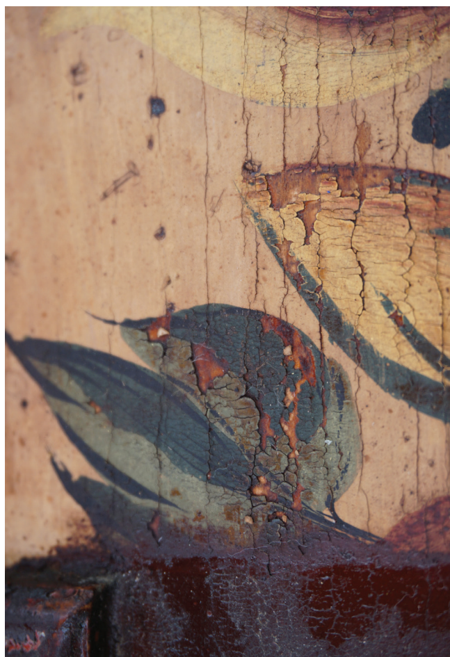
4. kép. A fa szálirányával egyezően berepedezett festés.
