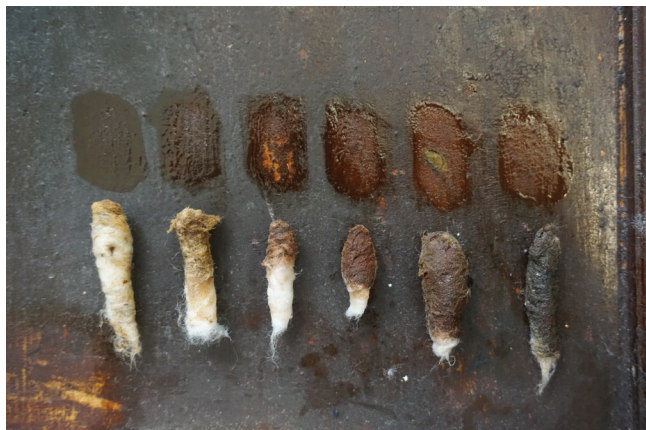
8. kép. Az átfestésréteg oldhatósági tesztjei nedves állapotban.
