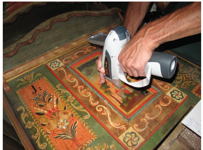
1. kép. A nagy laptéka 180(3?) pigmentjeinek vizsgálata Thermo Niton XL3t pXRF elemvizsgálóval.
