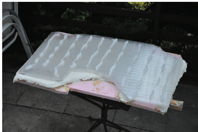
21. kép. Az egri Hyppolit freskó egy leválasztott eleme a számára lesabott polikarbonát lemezzel a ragasztáshoz felhordott acetátmentes egy komponensű szilikon-gumival.
