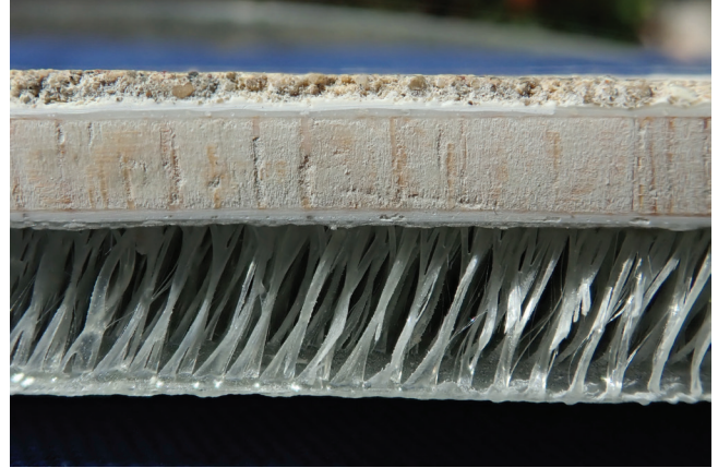
32. kép. A ParaGlass hordozó szerkezete a parafa elválasztó réteggel. A parafára a freskó epoxigyantával van felrögzítve.
