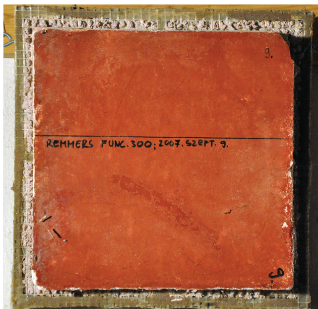
10. kép. A 9. számú kísérleti modell. Freskó üvegszálaspoliészter rácstra erősítve vízmentes etil-szilikát alapú vakolattal. A ragasztót leszámítva mindenben azonos az előzővel. Lényegesen kisebb romlás tapasztalható. A felerősítés kötőanyaga mindkét esetben szilikagél, csak ebben az esetben elkerültük a víz használatát.
