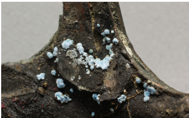
12. kép. A víztartály belsejében lévő fekete anyag (gyanta/fakátrány) és a rajta kiült réz korrózióstermékek (Nyíri Gábor felvétele).
