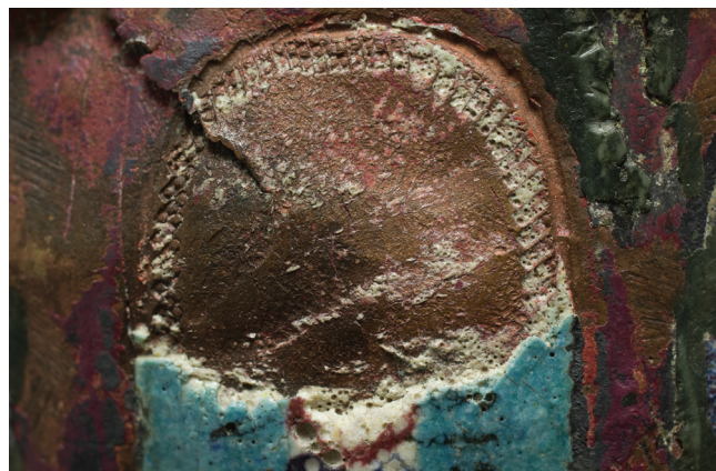
6. kép. Légbuborékok a zománcban, a beágyazott zománc helye, cizellálás nyomai (Nyíri Gábor felvétele).
