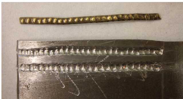
16. kép. Acéllemez présminta és kész, sárgaréz csőből lemezbe préselt oszlopelem pótlás.
