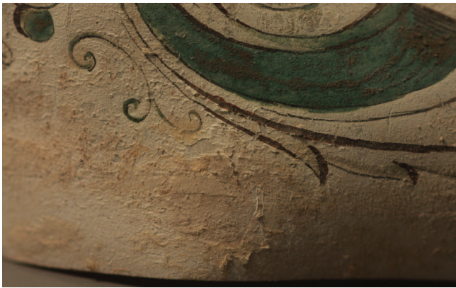
10. kép. A cserepesen felvált, kötőanyagát veszített mázszerű bevonat.
