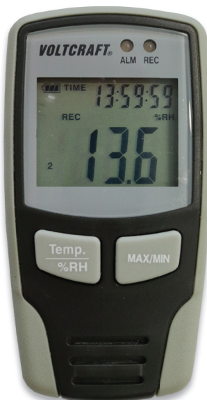
2. kép. Voltcraft DL-121 TH klíma adatgyűjtő.
