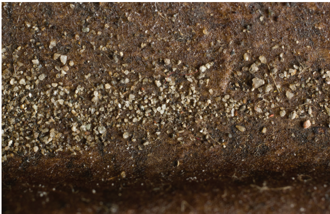
16. kép. Makró felvétel az ernyő felületén az olajbevonatba ragadt homokszemcsékről (Nyíri Gábor felvétele).
