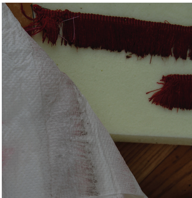
9. kép. A nedvesség által a segédanyag felületére kivált szennyeződés a Szent József-zászló rojtjainak száradása után.
