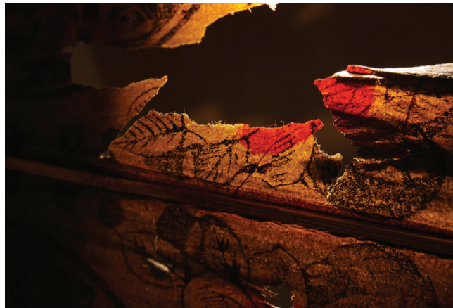
11. kép. Szabadon álló rostok a szakadások mentén (a szerző felvétele).
