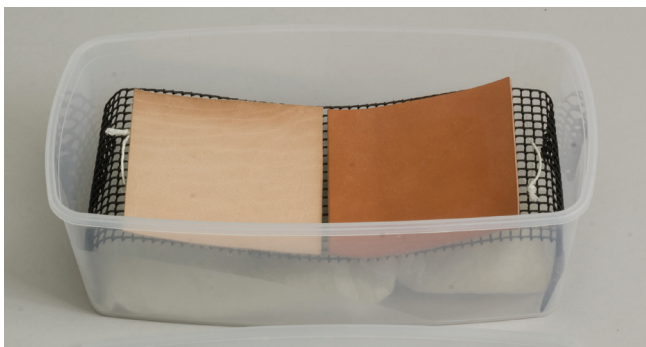
3. kép. A szilikagél és a minták elhelyezése a dobozokban.
