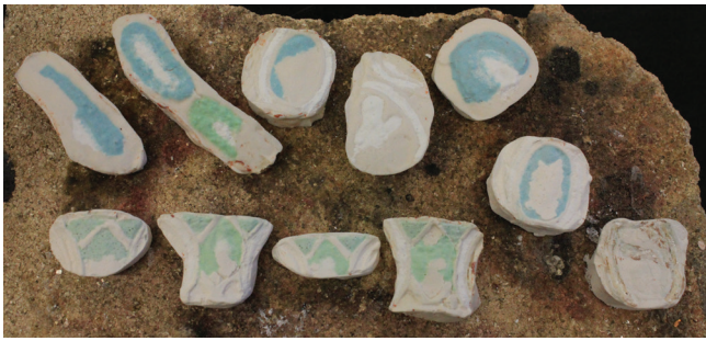
18. kép. Gipsznegatívba égetett zománcpótlások (a szerző felvétele).
