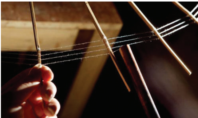
4. kép. A bordavégek cérnaszálakkal való megerősítése (Wu 2015).
