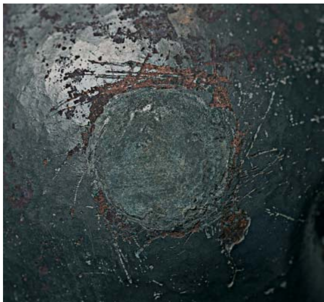
8. kép. A cuppa alján lévő forrasztás és a reszelő okozta nyomok (Bicskei József felvétele).
