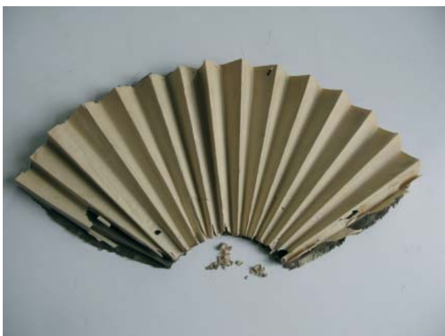
5. kép. Meggyengült, elsavasodott papír bélés (Kiss 2012).
