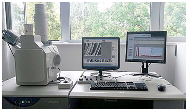
1. kép. A SEM-EDX vizsgálatokhoz használt HITACHI S-3400N, Quantax EDX berendezés (Gardánfalvi M. felvétele).
