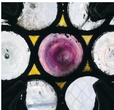
20. kép. Középlelem mangánnal színezve, restaurálás előtti állapot.
