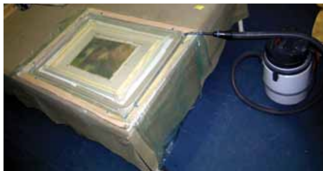
1. kép. Dublázás vákuumzseb eljárással a Magyar Képzőművészeti Egyetem Restaurátor tanszékén. Egy ipari porszívó adja a vákuumot.
