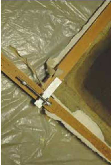
12. kép. A csavaros fesztítő szerkezet.
