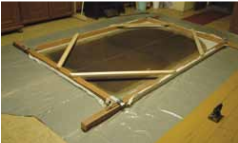
13. kép. A keret merevítése, stabilizálása egy bizonyos méret fölött elengedhetetlen.
