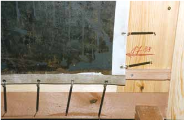
20. kép. A vásznat erre a feladatra tervezett és legyártott rugók feszítik.
