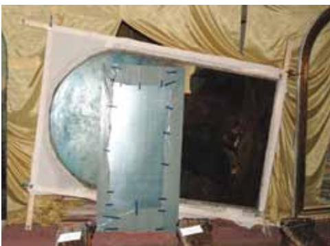
14. kép. A mágneses préseléshez a festett oldalra támasztott, fóliával borított bádoglemez.
