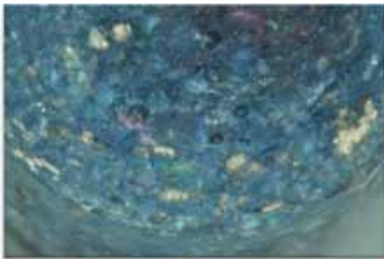
9. kép. Az opak vörös tessera (Szfv_1) vékonycsiszolatának részlete a vörös színért felelős kolloid méretű szemcsék eloszlását mutatja az alapüveg mátrixban. (PLM, az objektív nagyítása 40x).
