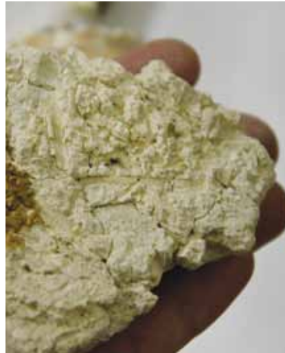
5. kép. Az alapvakolat struktúrája, növényi részletek lenyomata a beagyazó vakolat hátoldalán. Székesfehérvár, Szent István Király Múzeum, ltsz.: 718.
