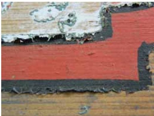
4. kép. A festékréteg felválása.
