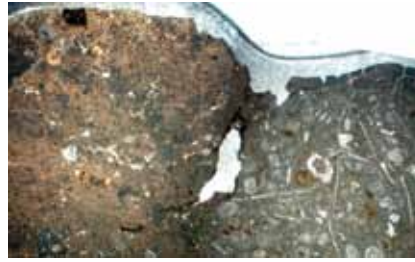
4. kép. A mészbázisú beagyazó vakolat mészkő töltőanyagot is tartalmaz, melynek szövet szerkezete is megfigyelhető. (PLM, 1N).
