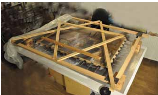
5. kép. A párásító sátor szerkezete. A festmény alatt mintegy húsz centiméterrel helyezkedik el a megnedvesített szintetikus fátyol. A sátrat úgy kell megépíteni, hogy a takaró-fólia ne érjen a festmény felületéhez.
