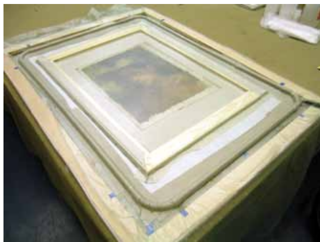
2. kép. A vákuumot vékony PVC csövekből készített elszívó-rendszerrel hozzuk létre. Ezzel két fólia közül kiszívjuk a levegőt. Az egymáshoz préselődő fóliák szorítják a vásznakat össze.
