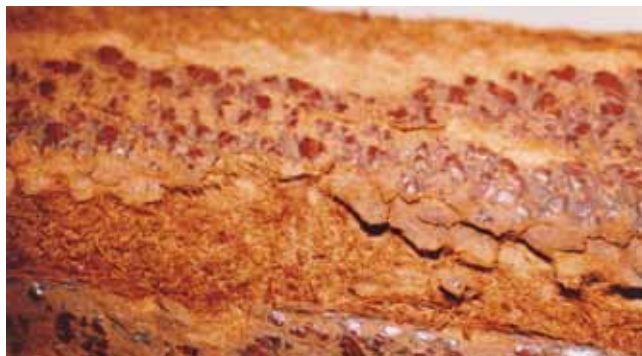
5. kép. Makro-felvétel a vörösbomlás jeleit mutató bőrfelületről.
