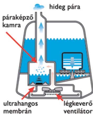
10. kép. Ultrahangos párasító készülék működési rajza (grafika: Kovács Dániel).
