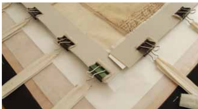
12–13. kép. Pergamen oklevél feszítése tépőzáras feszítőtáblán (fotó: Nyíri Gábor). Restaurátor: Sophie Kurtzman.
