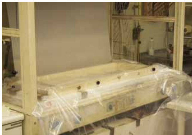
13. kép. Az elszívófülkébe épített szétbontható ideiglenes medence (Orosz Katalin felvétele).
