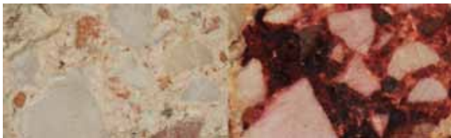
9. kép. A nucleus felső rétegéből származó minta Alizarin vörös S kezelés után. A vizsgálat alkalmas a kalcit és a dolomit elkülönítéséhez.
