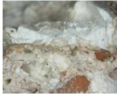
11. kép. A supranucleus és a nucleus felső rétege mészcsoomóval, sztereo-mikroszkópos felvételen.
