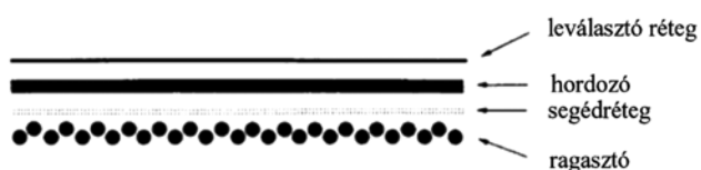
1. ábra. Nyomásérzékeny ragasztószalagok felépítése.
