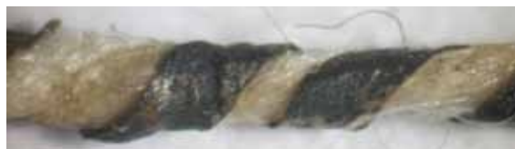
23. kép. Kombinált fém fonal mikroszkópos képe (fotó: Járó Márta).
