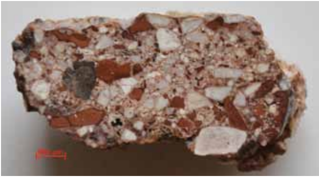
10. kép. A nucleus felső rétegének keresztmetszetén jól megfigyelhető a töltőanyagok (téglatörések és dolomit szemcsék) morfológiája.
