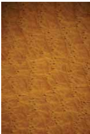
2. kép. Növényicszerzésű kecskebőr barkaoldalának mikroszkópos felvétele.
