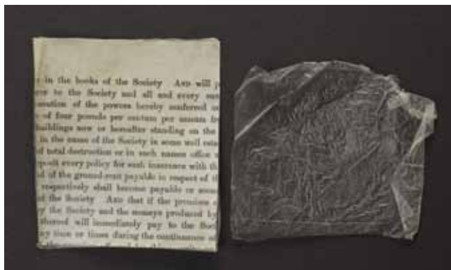
9. kép. Marhavakbél hártya (jobb oldalon) és a vele beborított pergamentőredék, melyen tökéletesen olvasható a rá nyomtatott szöveg (bal oldalon) (fotó: Nyíri Gábor).
