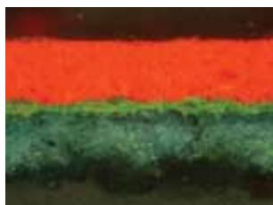
23. kép. Mikroszkópos keresztmetzet-csiszolat. A kék réteg átlagban 40–50 \mu m, a kék és sárga pigmentek keverékéből álló zöld réteg 20 \mu m, a vörös apró szemcsés homogén réteg 50 \mu m vastag.
