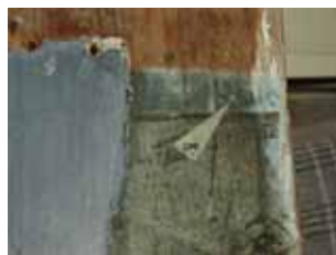
12–13. kép. Zöldeskék alapozás, takart, átfestés nélküli részről. Mintavételi hely és mikroszkópos keresztmetszet-csiszolat. A fa hordozón (400 \mu\text{m} ) a kék réteg 50 \mu\text{m} .
