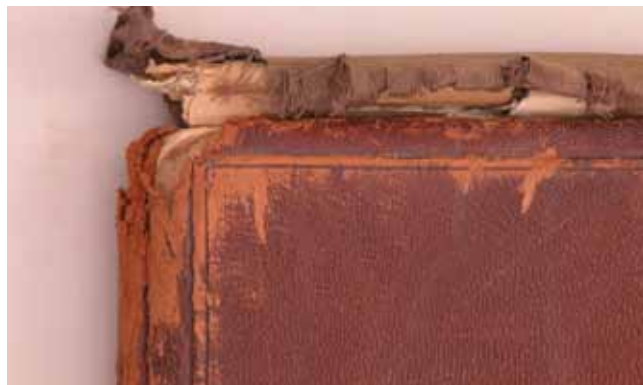
4. kép. Részlet a mappát borító, vörösbomlás jeleit mutató bőrből.
