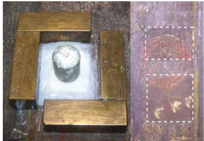
6. a-b. kép. a. Tisztítási próba Sympatex féligáteresztő membránon keresztül. b. A tisztítás eredménye.
